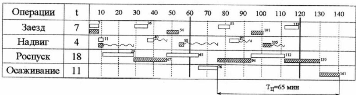
Рис. 8. График работы двух локомотивов
